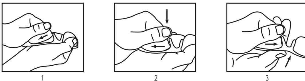
1. Sujete la montura hacia abajo tal como se muestra en la Figura 1. Deslice los cristales en su sitio, de manera que la pestaña del borde externo encaje en la ranura de la montura.
